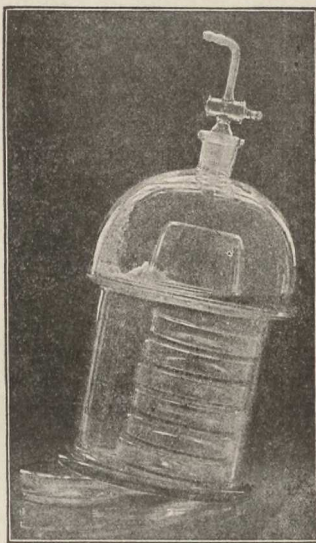
Fig. 21. En Vacuumexsikkator, benyttet til Dyrkning af anaërobe Bakterier.
