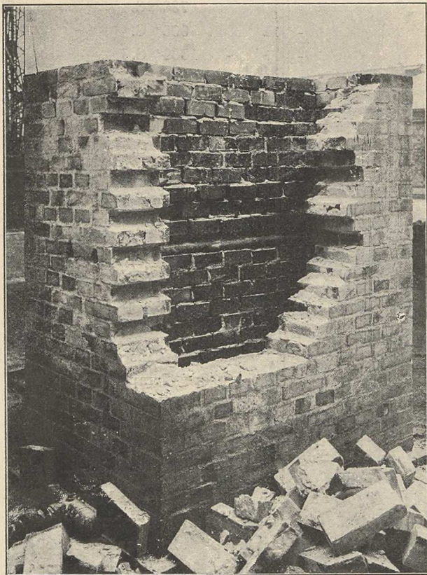
Fig. 32. Molers-Tværsmur i Brandforsøgshuset efter Forsøget.
