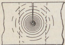
Fig. 78. Aabning af Snittet ved Svejsesflammens Paavirkning.
