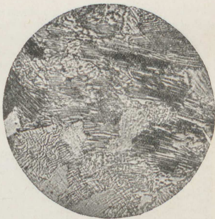
Fig. 62 b. Staal med ca. 0,75\frac{0}{0} Kulindhold. (300 g. Forstørrelse).
