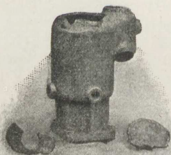
Fig. 131. Sprængt Motorcylinder før Reparationen.
