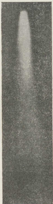
Fig. 35. Acetylen-Ilt-Svejseflamme med Overskud af Acetylen.
