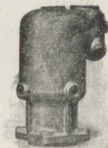
Fig. 132. Sprængt Motor- cylinder efter Reparationen.
