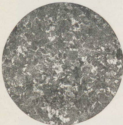
Fig. 62 a. Staal med ca. 0,75\frac{0}{0} Kulindhold. (300 g. Forstørrelse).
