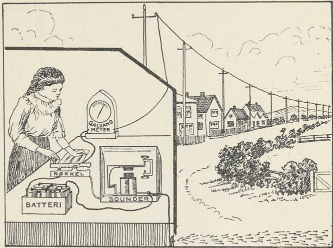
Fig. 84. Telegrammet sendes. De sorte traader fører i øieblikket strøm, de som er tegnet med dobbeltlinjer ikke.
