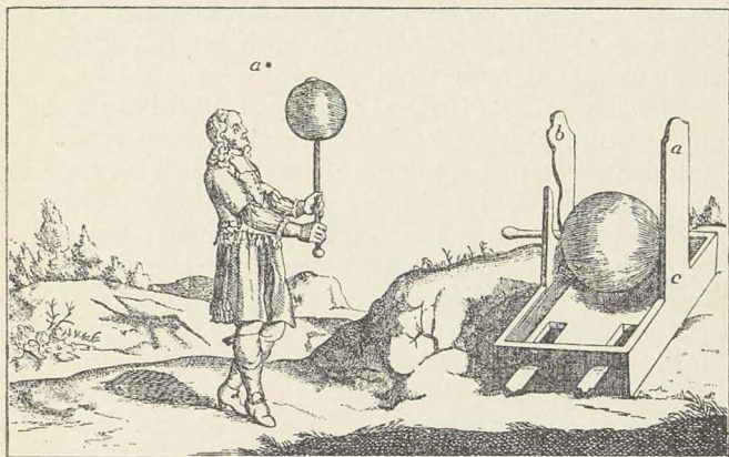
Fig. 1. Otto v. Guericke's elektrisermaskin (til høire). En svovelkule kan dreies om en aksel og gnedes ved at lægge haanden mot den. — Til venstre holdes svovelkulen paa en stang og dreies rundt. Et par elektriske dun holdes svævende omkring den bestandig med samme side mot kulen.
