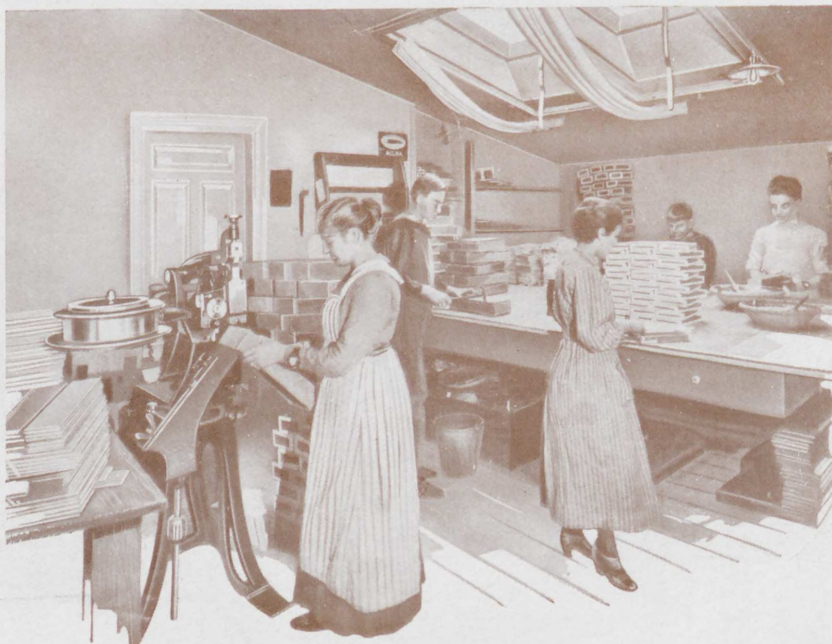
Cedertræet til Cigarkasserne modtages fra Udlandet i tilskaarne Stykker. Ved Hjælp af Heftemaskiner heftes disse sammen til Kasser efter samme System som paa en Symaskine, hvorefter Kasserne forsynes med Strimler og Etiketter.
