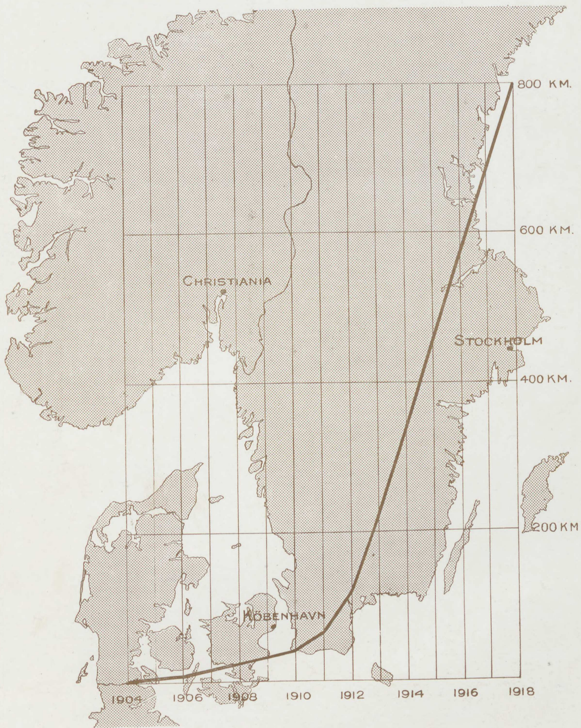
DIAGRAM VISENDE SAMLET LÆNGDE AF PÆLE RAMMEDE I AARENE 1904-18.
