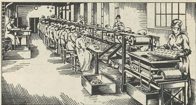
Abb. 120. Verpackungstransporteur in einer Keksfabrik, dreifach wirkend: 1. für die lose Ware, 2. für leere Kartons, 3. für fertiggepackte Kartons.
