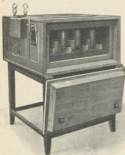
Abb. 80. Brutschrank für die Sterilitätsprüfung.
