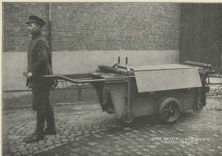
Abb. 110. Der Einachsschlepper mit Einrichtung zum Tragen von Lasten.
