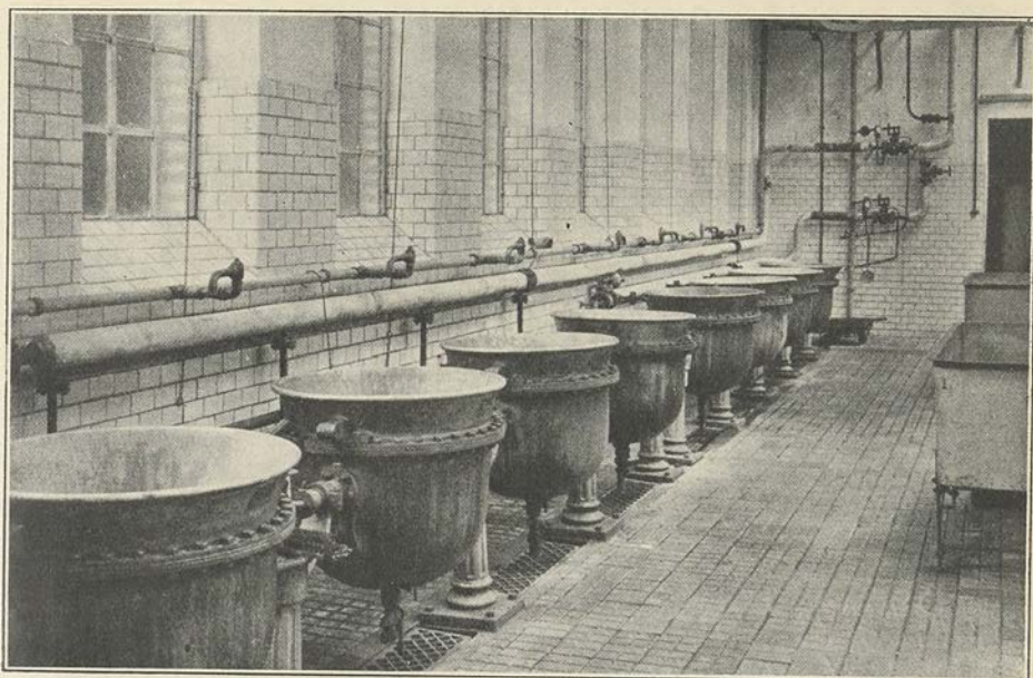
Abb. 18. Ansicht einer Blanchier- und Kochkesselbatterie aus der Gemüse- und Obstkonservenfabrik Gustav Brentke in Gerwisch bei Magdeburg.
