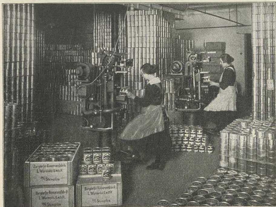
Abb. 83 u. 84. Anker-Etikettiermaschine und Anker-Etikettiermaschine „Colibri“ für kleine Packungen im Betrieb der Fischkonservenfabrik C. F. Stühr & Co., Hamburg.
