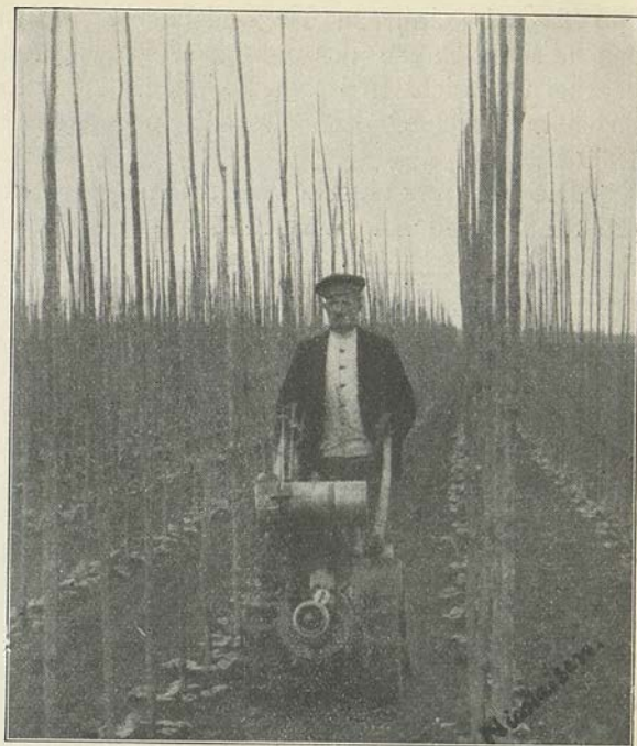
Abb. 5. Bodenfräse bei der Hackarbeit in einem Stangenbohnenquartier.
