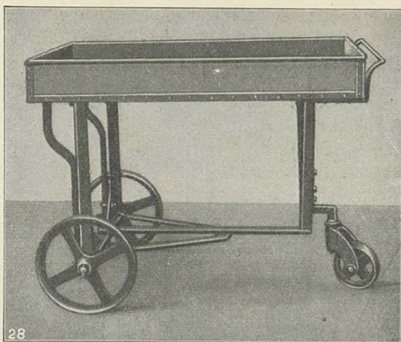
Abb. 101. Eiserner Transportwagen für Konservendosen. Bequeme Transportmittel für Konservenküchen.
