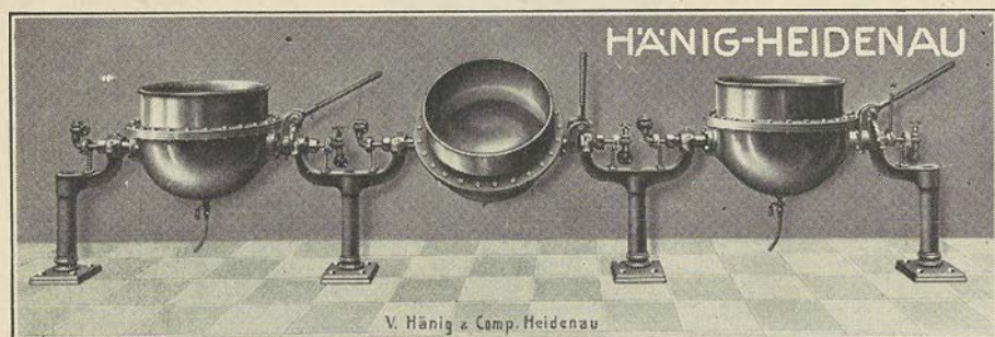
Abb. 16. Blanchierkessel in Batterieform.
