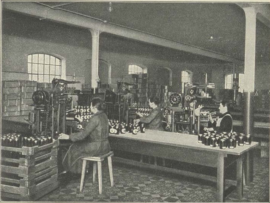
Abb. 82. Ankersche Etikettiermaschinen aus der Marmeladenfabrik L. Oetker, Bahrenfeld.
