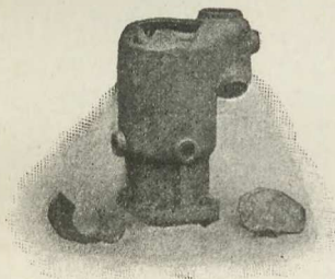
Fig. 131. Sprængt Motorcylinder før Reparationen.
