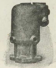
Fig. 132. Sprængt Motorcylinder efter Reparationen.
