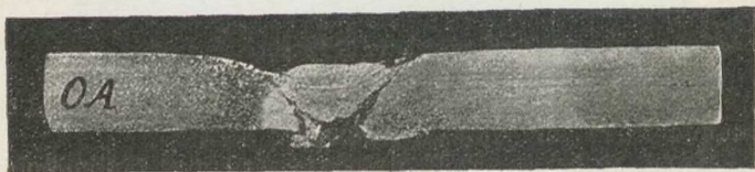
Fig. 59. Tværsnit gennem en særlig daarlig Svejsefuge.
