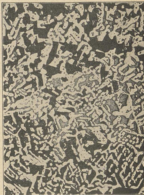
Abb. 11. Mikrophotographie einer porösen Antimonplatte bei 40facher Vergr.
