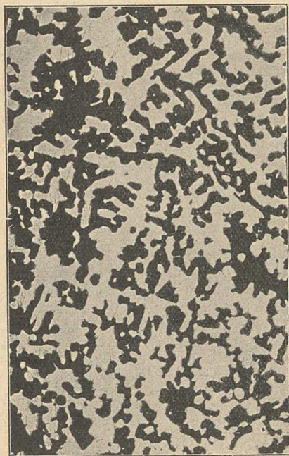
Abb. 10. Mikrophotographie einer porösen Zinkplatte bei 40facher Vergr.
