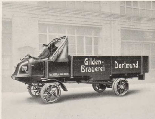
Elektrischer Wagen für 5 t Nutzlast
