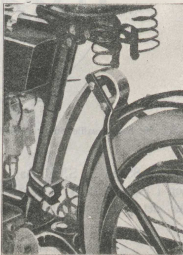
Fig. 88. Baghjulsaffjedring ved Bladfjedre paa „Magnet“-Motorcyklen.
