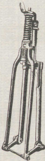
Fig. 85. „N. S. U.“-fjedrende Forgaffel.
