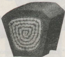
Fig. 62. Tværsnit gennem en „Hexagon“-Gummirem.
