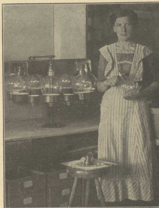
Fig. 389. Herstellung der elektrischen Metallfadenlampen: Anbringung der Messingsockel unter Erhitzen durch Gas.
