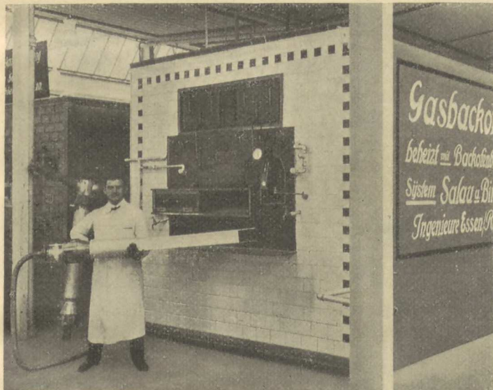
Fig. 339. Einherdiger Holzbackofen von Schmotz, geheizt mit Gasbrennern von Salau & Birkholz.
