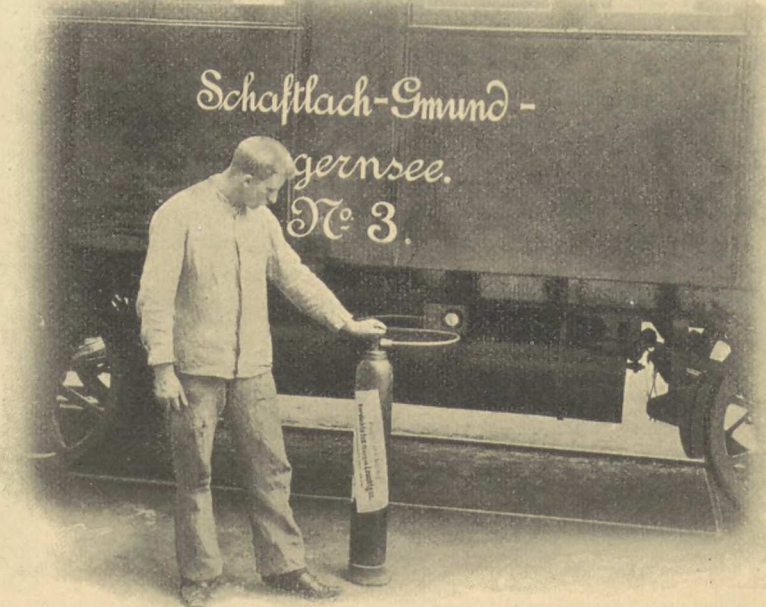
Fig. 411. Füllung des Gaskessels eines Eisenbahnwaggons mit Blaugas.
