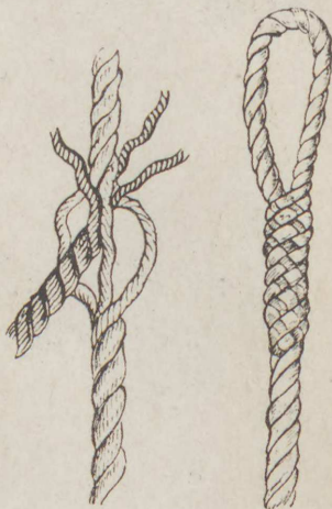
Fig. 141. Spleisning av en endeløkke.
