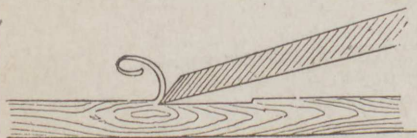
Fig. 3. Hvorledes hugjernet skal holdes.
