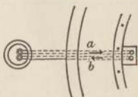
Fig. 88. Ind- (a) og Udløberingen (b) af Gas i Gasometret.
