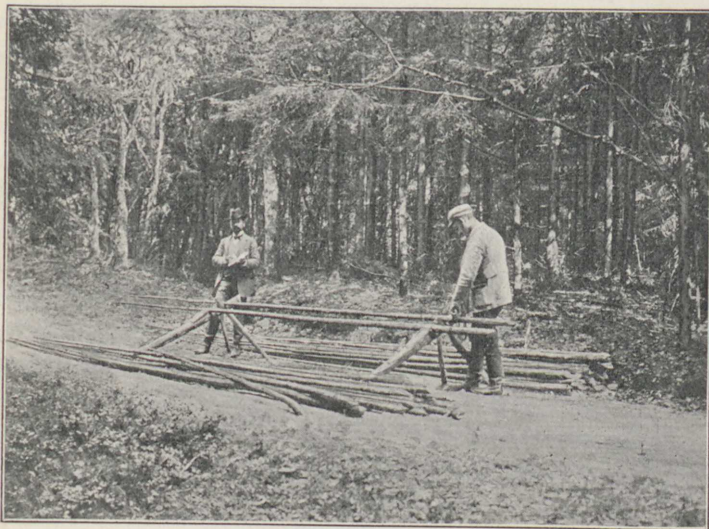
Fig. 5. Klupning af Lægter paa Bukke.
