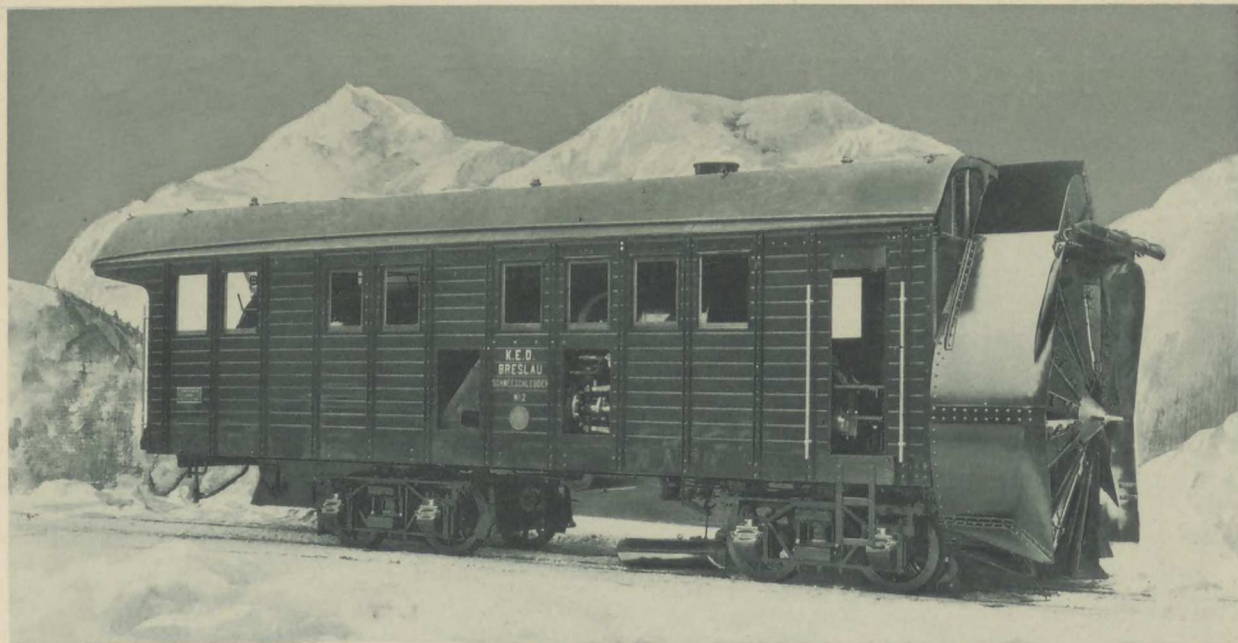
4 achsige Dampfschneeschleudermaschine für die K.E.D. Breslau (1906).
