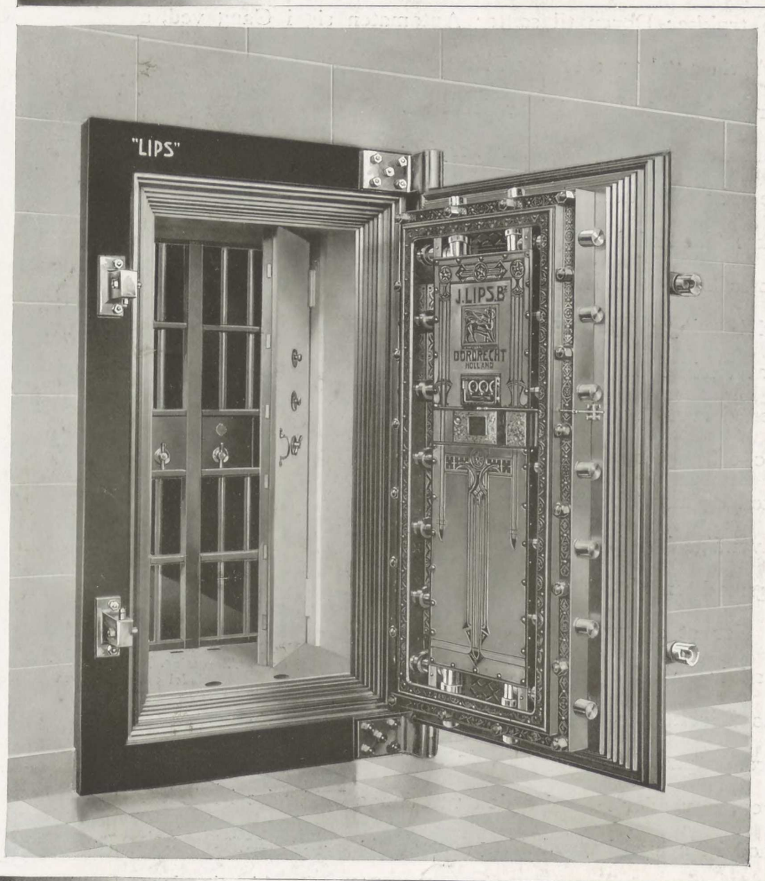
Rigelværket bevæges ved en Automat og aflaaes ved en tredobbelt Tidslaas. Imellem Hoveddøren og Gitret er anbragt en indre Panserdør, der aflukkes ved 2 Zifferlaase, og hvis to Fløje, naar de aabnes, slaa tilbage langs med Karmens Sidevægge.
