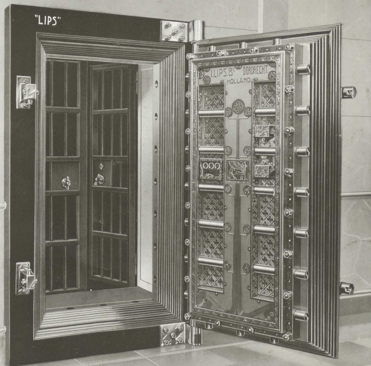
Rigelværket bevæges ved Haandtag og Spindel, aflaaes ved 2 samvirkende Zifferlaase og en tredobbelt Tidslaas.
